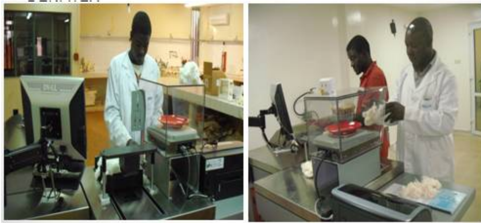
Opération de classement instrumental du coton sur la Chaîne de Mesures Intégrées USTER HVI 1000
