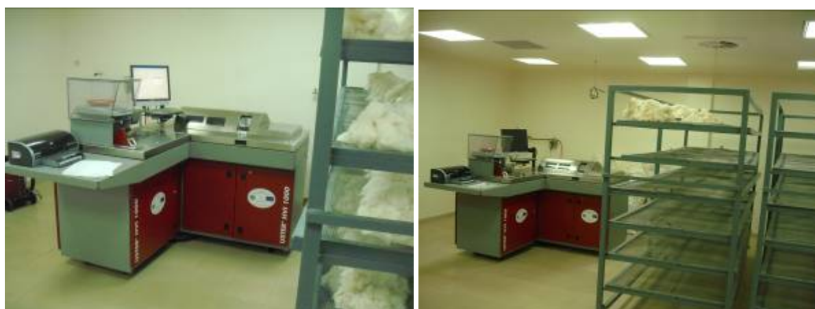
Chaîne de Mesures Intégrées Uster HVI 1000 M700
